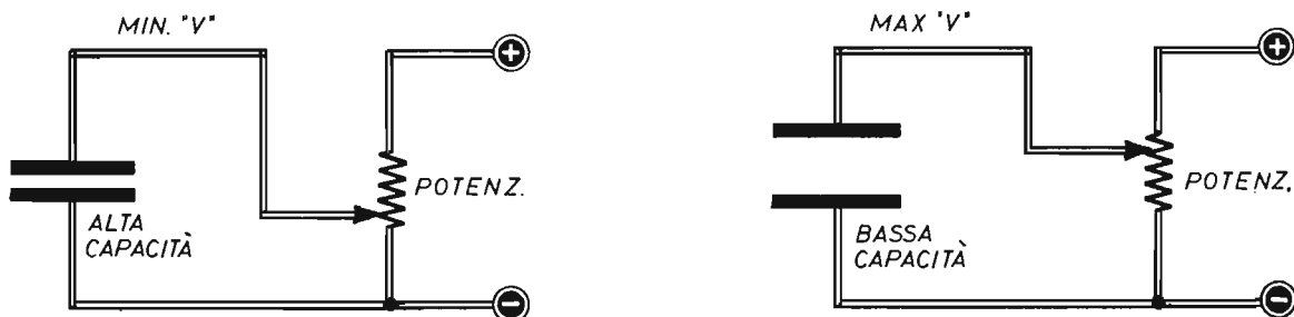
Fig. 5 - Il potenziometro R4 regola la sintonia del ricevitore facendo variare la tensione inversa applicata agli elettrodi del diodo varicap, qui raffigurato come un normale condensatore. In corrispondenza del valore minimo di tensione si raggiunge il massimo valore capacitivo. Viceversa, alla massima tensione corrisponde la minima capacità (schema a destra).
